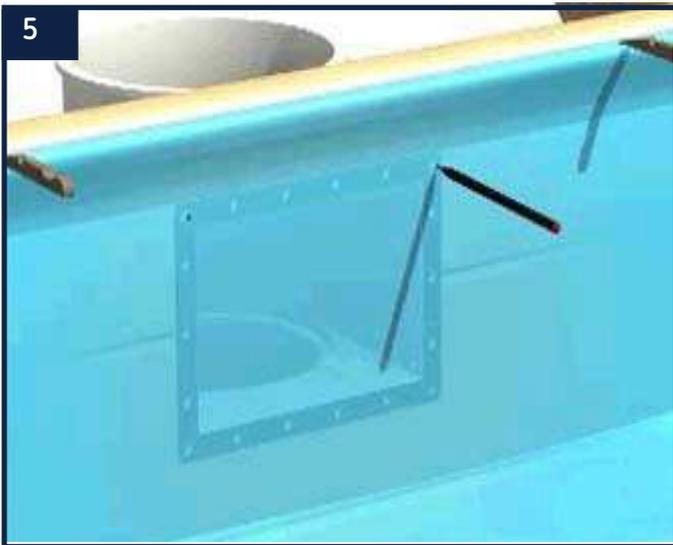
Remontez le niveau d'eau à 5 cm sous l'ouverture du skimmer, puis placez le deuxième joint sur la face avant du skimmer, devant le liner.
