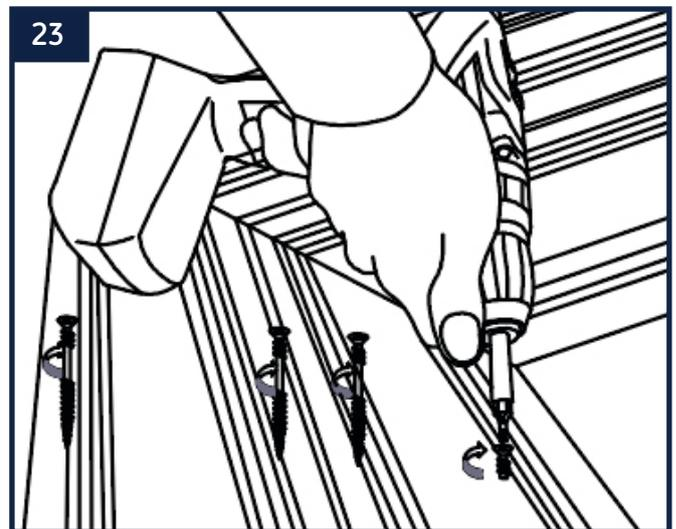
Fixez les margelles à l'aide des vis 5 x 60 mm (H) en commençant par les margelles intérieures. Celles-ci sont fixées sur l'ossature bois et sur le croisement des parois de la piscine. Fixez ensuite les margelles extérieures sur les supports de margelles ou sur les renforts horizontaux lorsqu'il s'agit de grandes longueurs ou de la paroi de l'escalier.
