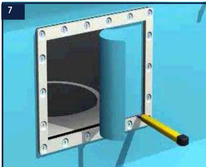
Découpez soigneusement le liner à l'intérieur de la bride à l'aide d'un cutter. Puis montez le niveau d'eau jusqu'à la moitié du skimmer.
