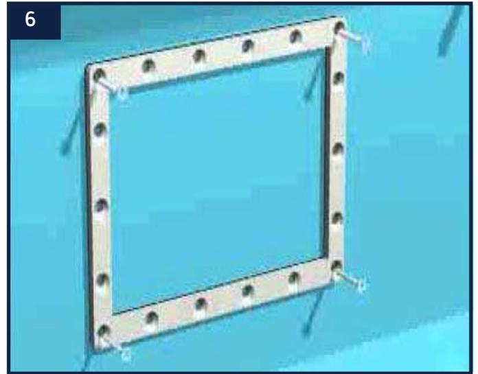
Positionnez la bride en respectant son sens (répérez sur la face interne les réservations pour les vis à tête rondes utilisées pour le premier joint) et vissez-la en utilisant les 10 vis inox à tête plate.
