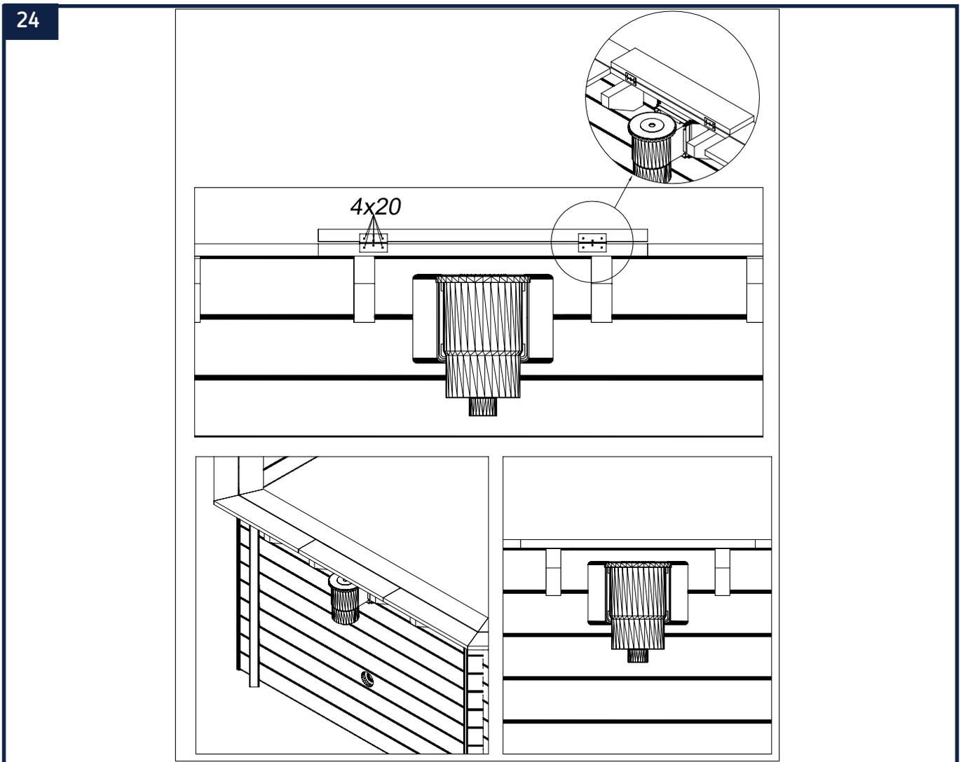
Fixez, à l'aide des vis 4 x 20 mm (C), les charnières (A) sur la tranche de la margelle amovible (10) et la tranche de la margelle intérieure 9 positionnée au niveau du skimmer comme indiqué sur le schéma ci-dessus.
