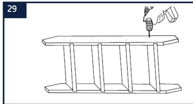
29 Une fois les trous indiqués, percez-les à l'aide d'une perceuse équipé d'un foret de 3 mm.
