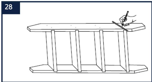
28 Utilisez une règle et un crayon de papier pour indiquer l'emplacement des trous qui permettront de fixer les marches.
